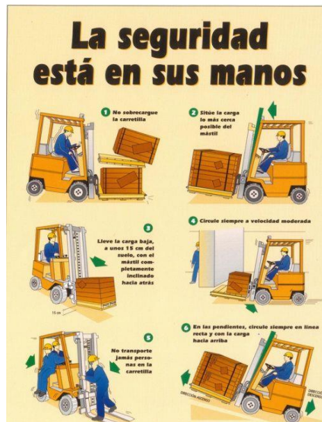
Figura III.36 Uso correcto del montacargas y lo que se debe evitar. Fuente: Pinterest, 2022.
